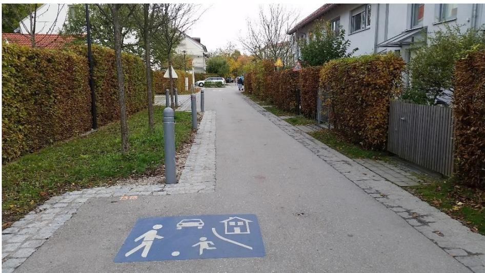
Abbildung 37: Piktogramm auf der Fahrbahn, Fahrbahneinengung zur Verkehrsberuhigung und Förderung der gegenseitigen Rücksichtnahme
